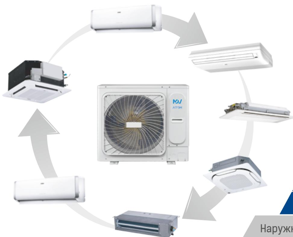
Серия мини VRF-систем ATOM представлена линейкой из девяти наружных блоков (от 3,5 до 17,5 кВт), а также несколькими типами внутренних блоков: настенные, кассетные, напольно-потолочные и канальные, производительностью от 1,5 до 16 кВт. К одному наружному блоку можно подключить от 1 до 9 внутренних. Наружные блоки серии ATOM совместимы только с внутренними блоками серии ATOM.
