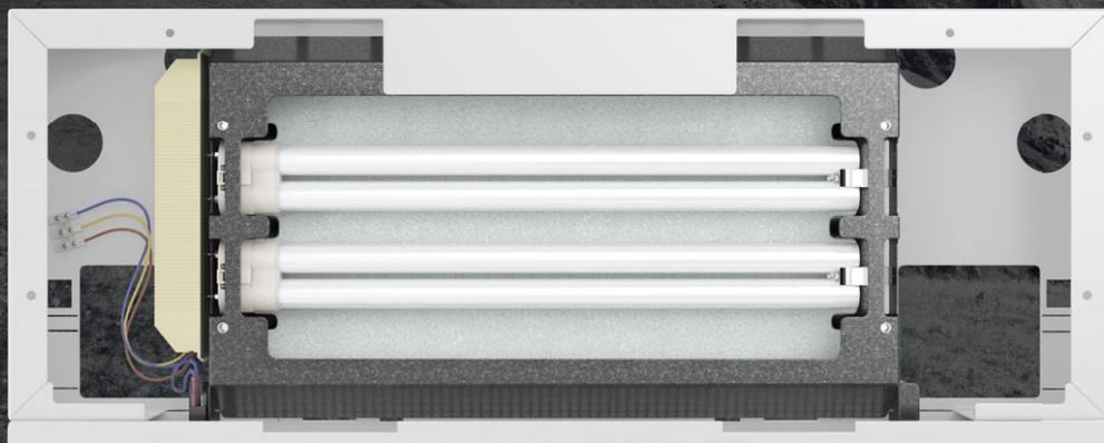
Модуль обеззараживания воздуха Energolux DUF устанавливается вместе с внутренним блоком сплит-системы, образуя с ним единую конструкцию
