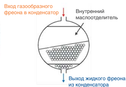
Встроенный маслоотделитель конденсатора
