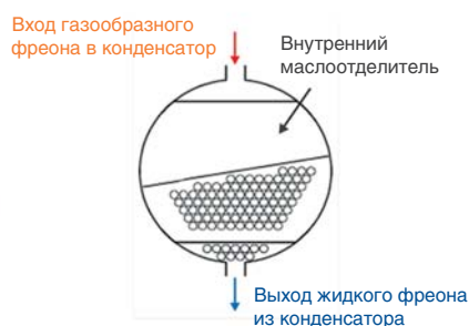
Встроенный маслоотделитель конденсатора
