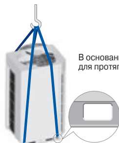
Подъем и размещение наружного блока на монтажной позиции может осуществляться краном.
