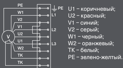
Схема 3 (Δ — 400 В, 3 ф.)
